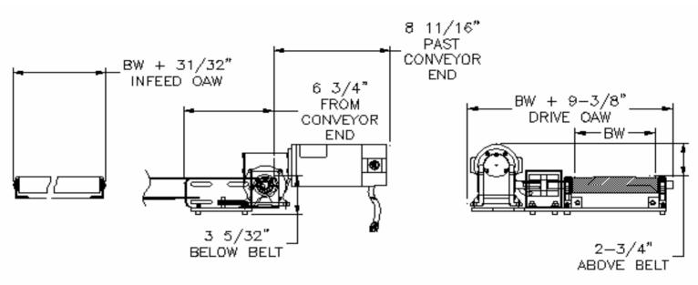
END DRIVE SHAFT MT RT ANGLE DISCHARGE FACING
